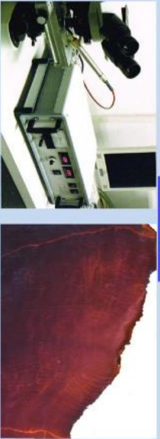
La cathodoluminescence (CL) est l'émission de lumière par un solide soumis à un bombardement d'électrons. Cette technique permet de caractériser des matériaux sous microscope optique ou sous microscope électronique à balayage MEB. *The cathodoluminescence (CL) is the emission of light by a solid subjected to an electron bombardment. This technique is used to characterize materials under an optical microscope or under a SEM scanning electron microscope.*
